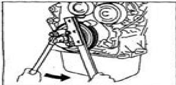
б) Снимите шкив коленчатого вала с помощью съемника.
