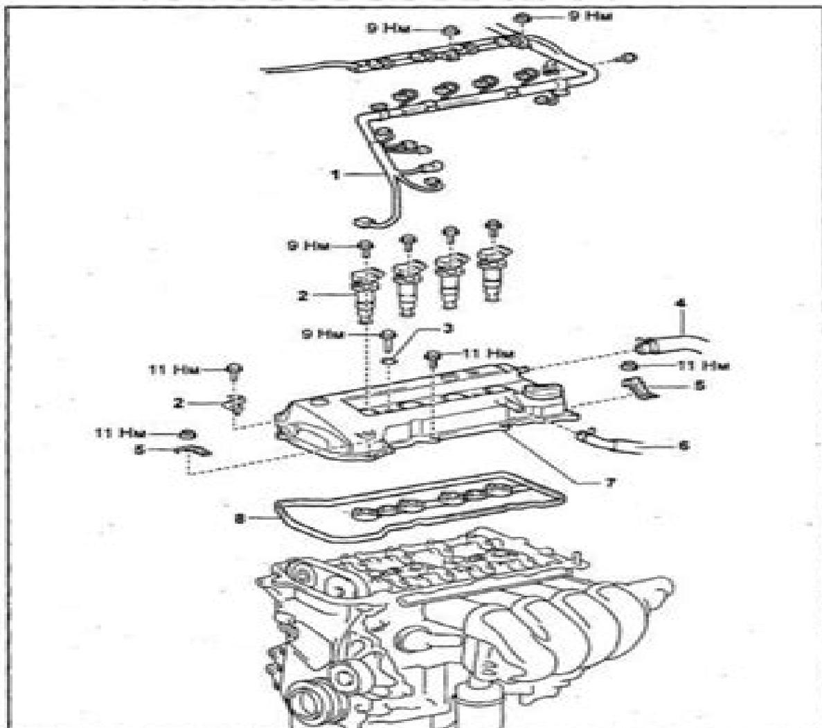
Снятие цепи привода ГРМ (этап 2). 1 - жгут проводов двигателя, 2 - катушка зажигания в сборе, 3 - шайба, 4, 6 - шланг системы принудительной вентиляции картера, 5 - кронштейн, 7 - крышка головки блока цилиндров, 8 - прокладка.
